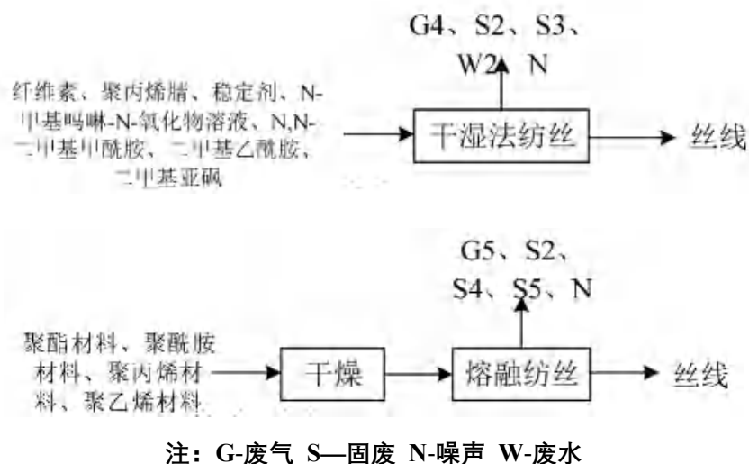
图 3.1-8 现有项目纺丝实验研发主要工艺流程及产污环节示意图
