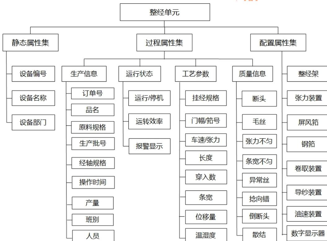
图 6 整经单元信息模型架构图
