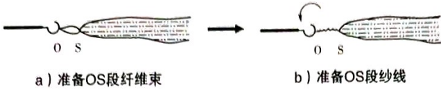
图 B.3 纤维条初步加捻示意图
